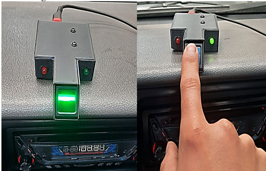
Pruebas de funcionamiento en sensor de huellas. Autores: Stalin Chuquitarco
