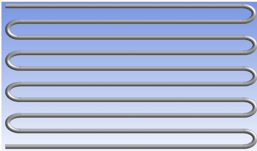
**Figura 22.** Geometría del evaporador tipo serpiente en software especializado ANSYS.
