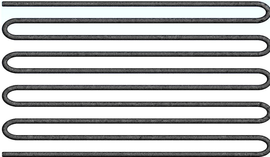
**Figura 23.** Mallado de la geometría (ANSYS).
