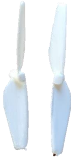
Figura 45. Hélice impresa a un ángulo de 45°
