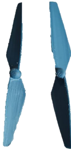
Figura 37. Hélice impresa a un ángulo de 35°
