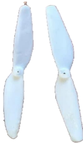
Figura 33. Hélice impresa a un ángulo de 30°.
