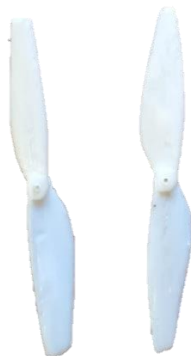
Figura 29. Hélice impresa a un ángulo de 25°
