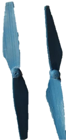
Figura 41. Hélice impresa a un ángulo de 40°
