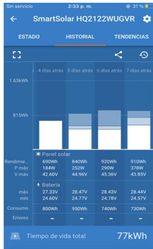
Figura 41. Registro de valores energéticos del sistema solar
