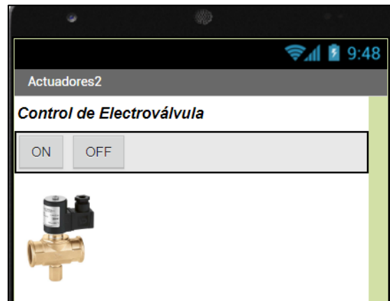
Control de la electroválvula por Bluetooth. Fuente: Hernández K, Quishpe L.
