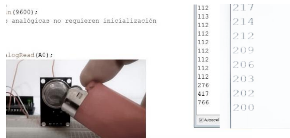
Figura 3.4: Prueba con gas Butano y GLP
