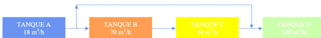
**Figura 14.** Diagrama de conexión de tanques del servicio de agua potable del barrio Cuendina.
