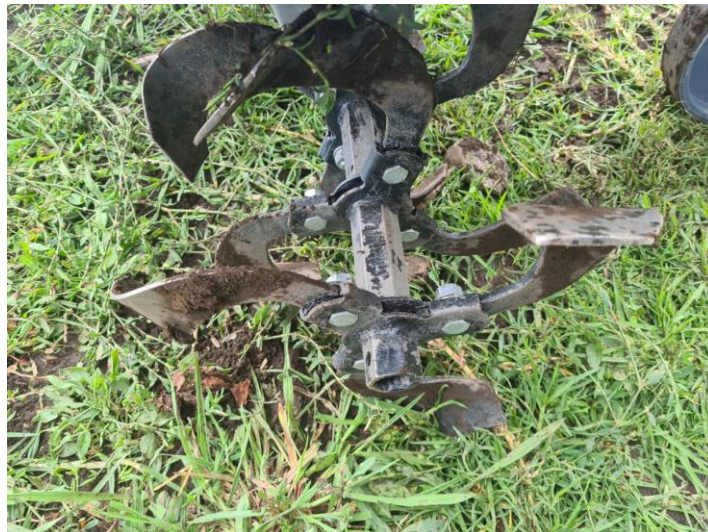
Figura 26. Desgaste de las cuchillas
