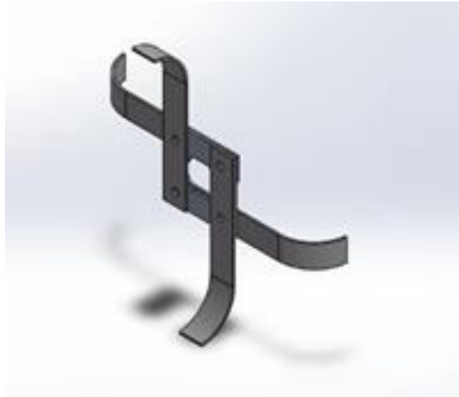
Figura 24. Sólido del patrón de cuchillas a utilizar modelado en CAD
