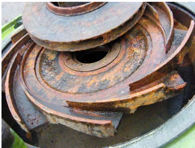
Figura 5. Efecto abrasivo en un impulsor de bomba. Fuente: Tomado de Google, 2022.
