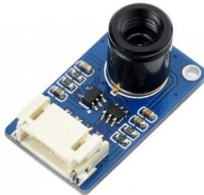
Cámara para medición de temperatura Fuente: (Melexis,2019)
