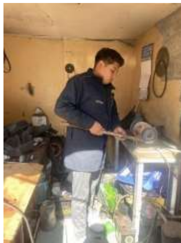
Figura 39. Limpieza del corte realizado
