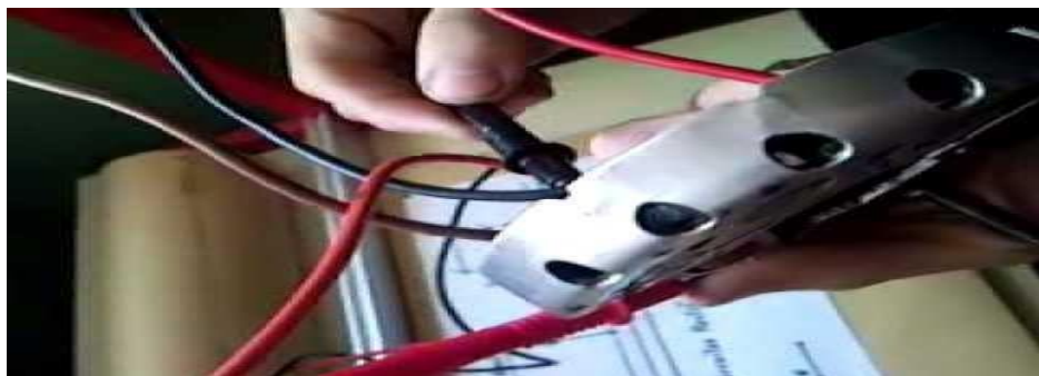
Figura.1.13 Comprobación del puente rectificador de diodos
