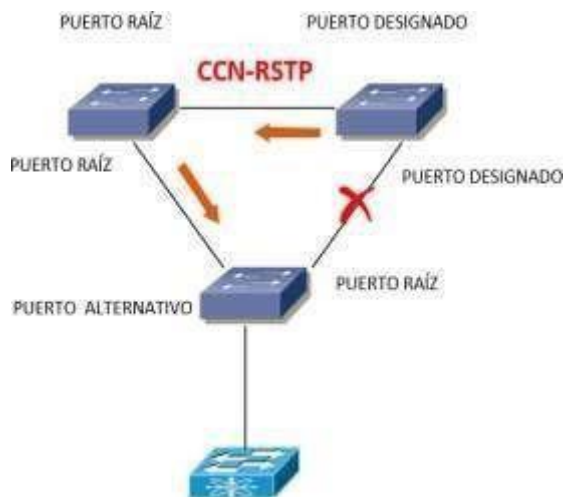
Ilustración 54 Diseño funcional de RSTP en la nueva red de la CCN. Elaborado por. Andy Navas y Amy Garay
