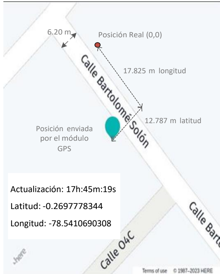
Figura 4.1. Distancias obtenidas en latitud y longitud con respecto al valor real (0,0) del módulo GPS.
