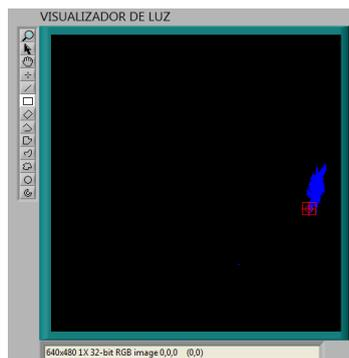
**Figura 3.2** Movimiento aleatorio del puntero a causa de una imagen plantilla grande
