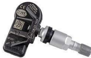
Figura 2.59 Sensor de presión y temperatura tipo válvula Fuente: (Bartec Usa, s.f.)
