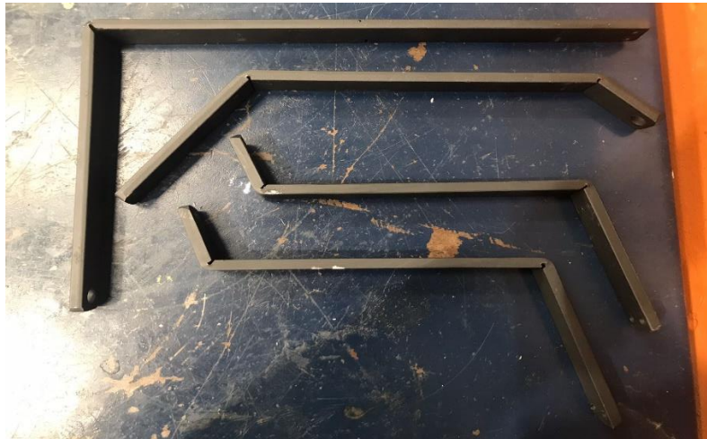
Figura 2.53 Bases terminadas para el montaje de los sensores
