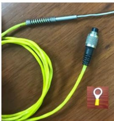
Figura 2.55 Materiales utilizados para la creación de la termocupla
