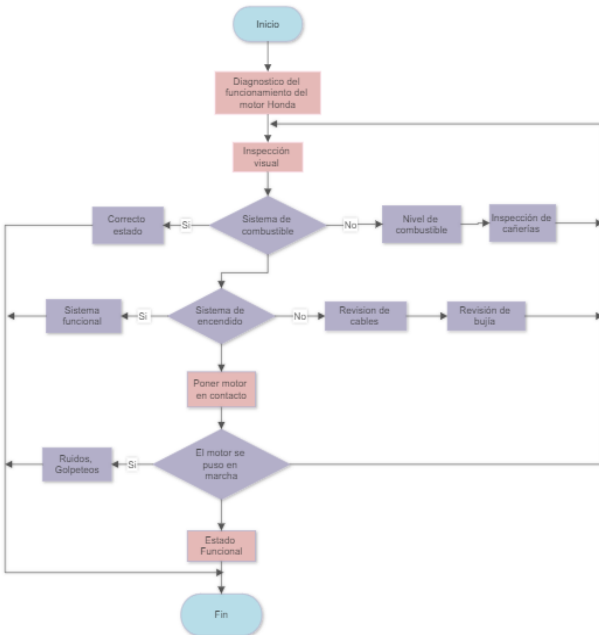
Figura 2.1 Diagrama de flujo del diagnóstico del motor Honda
