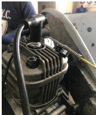
Figura 2.57 Termistor instalado en el motor Fuente: (Autores).
