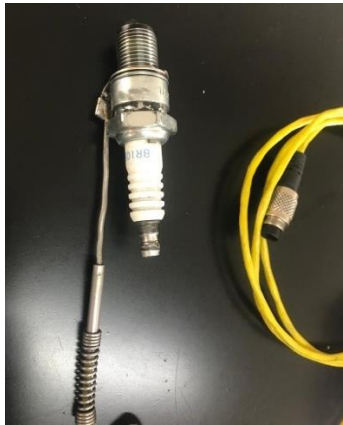
Figura 2.56 Termistor instalado en la bujía del Gokart Fuente: (Autores).
