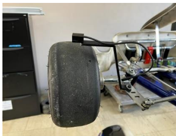
Figura 2.61 Sensor frontal izquierdo instalado Fuente: (Autores).
