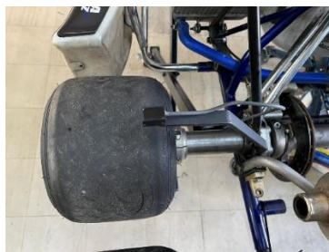
Figura 2.62 Sensor posterior izquierdo instalado Fuente: (Autores).
