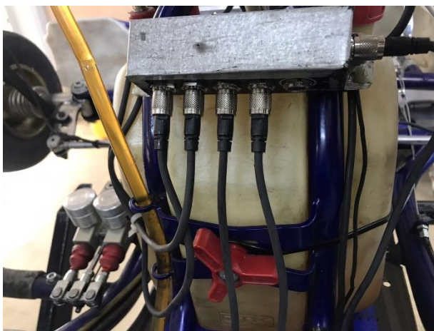
Figura 2.63 Acople de los sensores al extensor del Mychron Fuente: (Autores).
