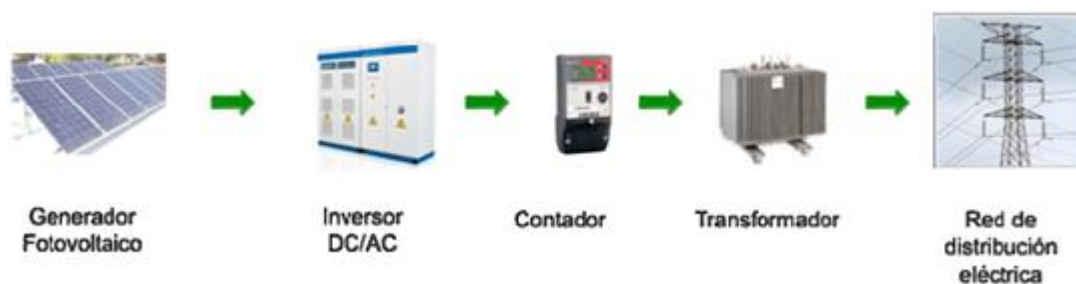
FIGURA 35 ESQUEMA GRAFICO DE LOS PASOS DE LA CONVERSIÓN ELÉCTRICA.
