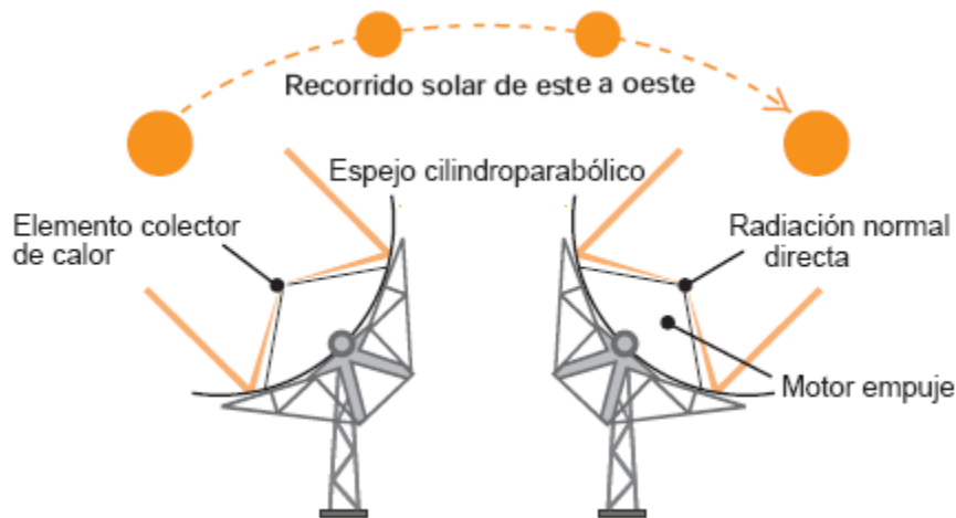
FIGURA 10. PRINCIPIOS DE OPERACIÓN Y TRAYECTORIA DIARIA DE UN COLECTOR PARABÓLICO.
