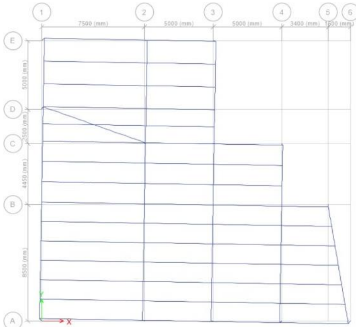
Figura 33. Tercer Modo de Vibración
