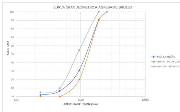
Figura 5. Curva granulométrica agregado grueso de montaña.
