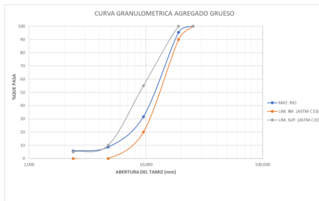
Figura 6. Curva granulométrica agregado grueso de río.
