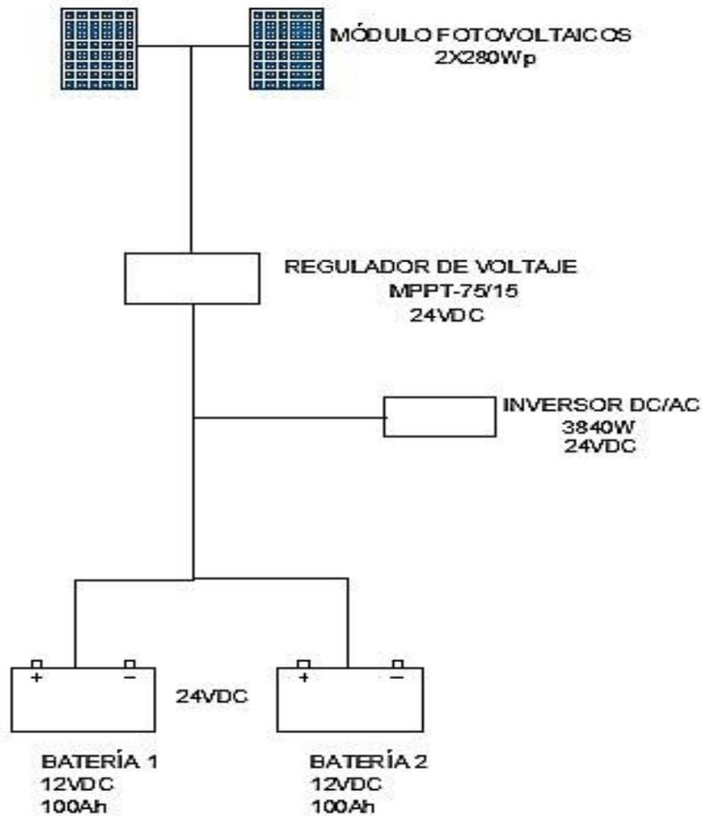
Ilustración 4 - Esquema Unifilar del Sistema aislado
