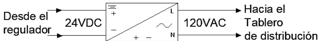
Ilustración 29 - Conexión del inversor
