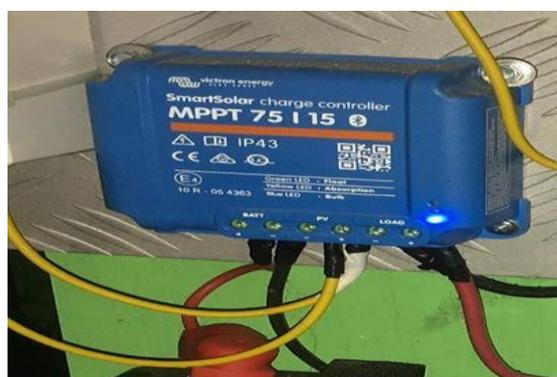
Ilustración 12 - Controlador de carga en sitio
