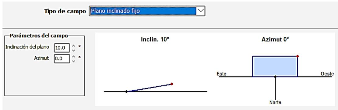
Ilustración 34 - Angulo de inclinación del FV
