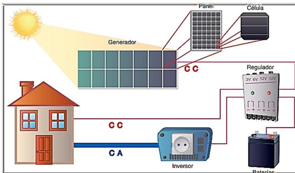
Ilustración 9 - Sistema fotovoltaico aislado
