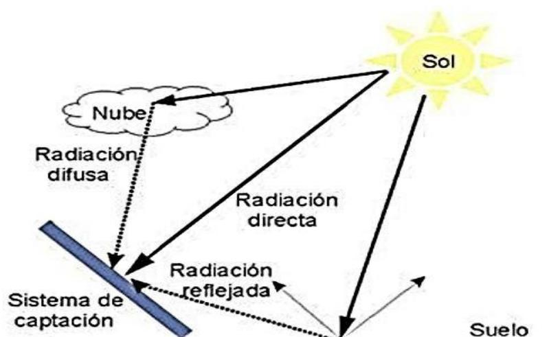
Ilustración 7 - Radiación emitida sobre la superficie de la tierra
