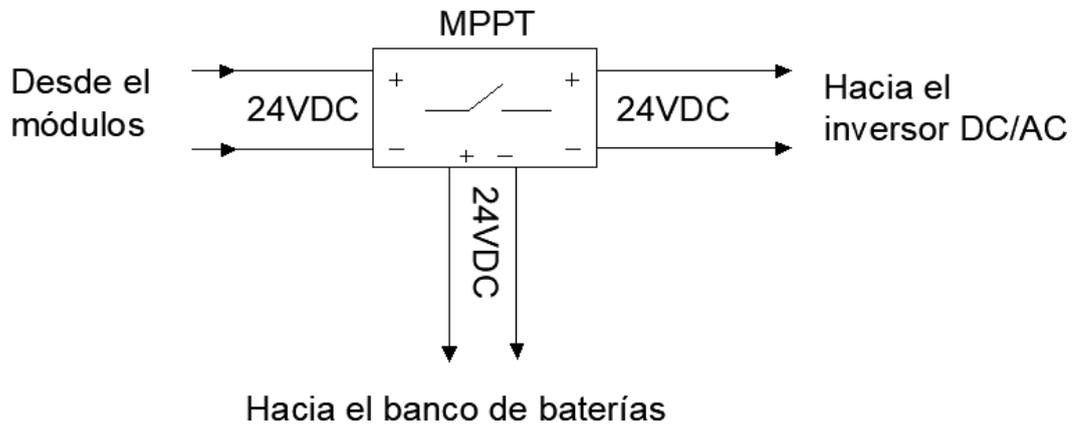
Ilustración 28 - Conexión del controlador de carga
