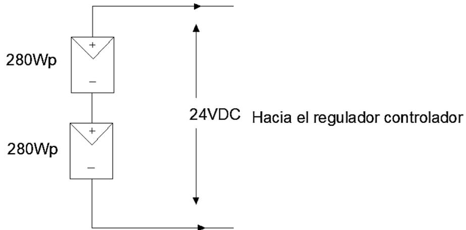
Ilustración 26 - Conexión de los módulos fotovoltaicos
