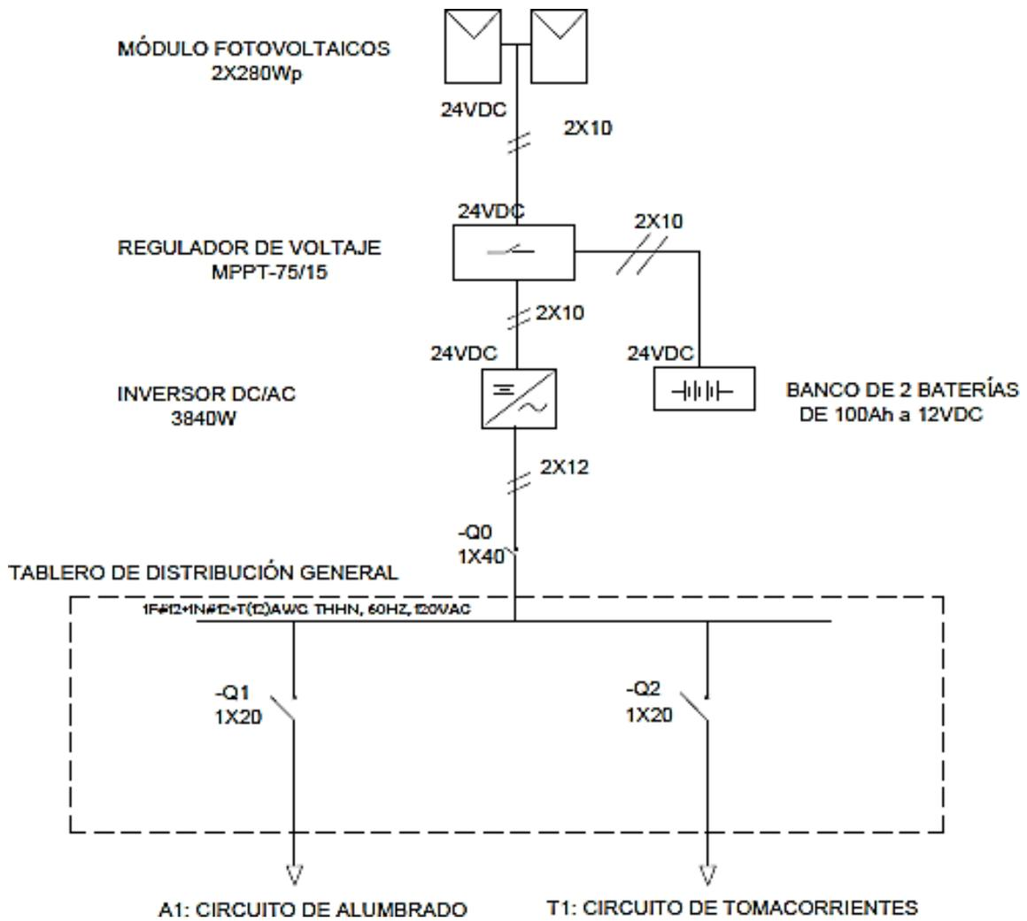
Ilustración 25 - Diagrama unifilar del SFVA
