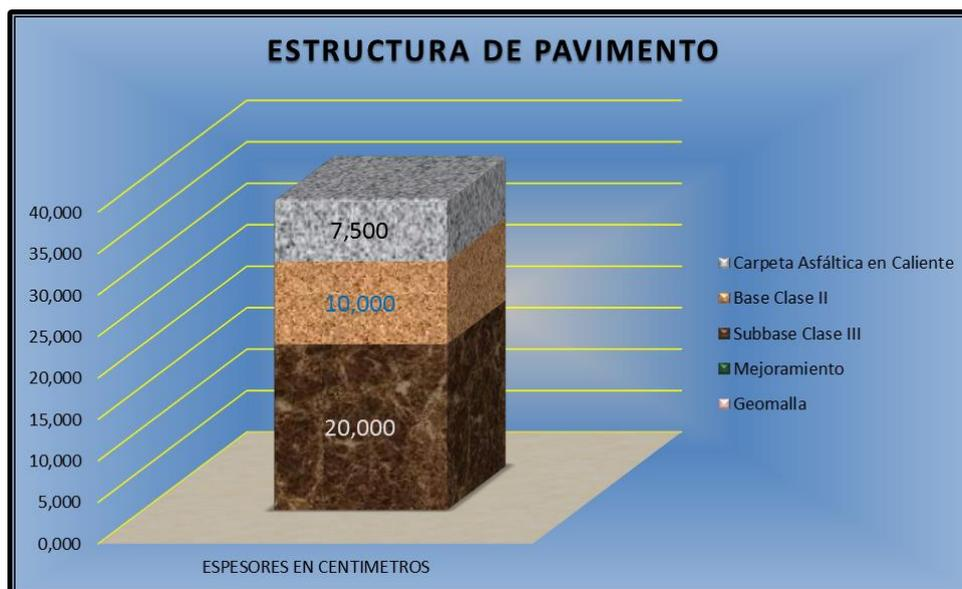
*Nota.* Se muestra la conformación y espesores de las capas del diseño de pavimento flexible. Elaborado por: El Autor mediante plantillas de Excel.
