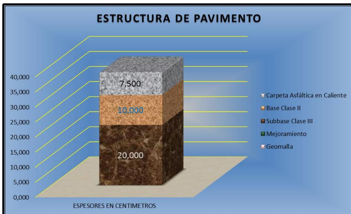
*Nota.* Se muestra la conformación y espesores de las capas del diseño de pavimento. Elaborado por: El Autor mediante plantillas de Excel.
