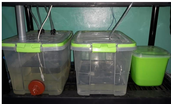
Figura 18: Tanques de almacenamiento de agua recirculante, potable y solución nutritiva
