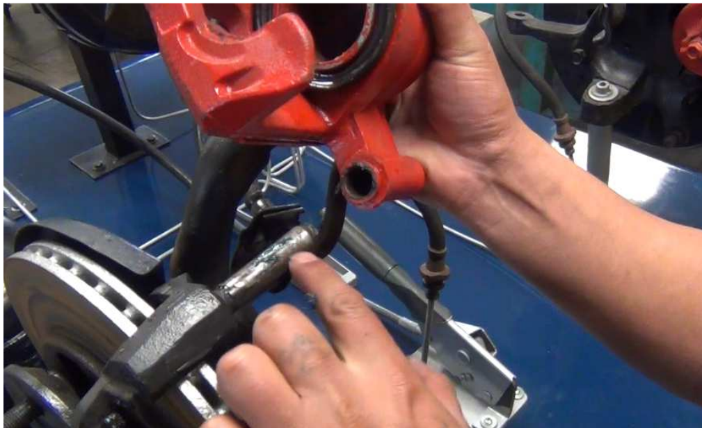
Figura 4.22 Engrasado de guías de la mordaza. Fuente: Los Autores
