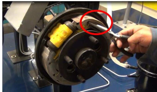
Figura 4.6 Extracción de muelles de recuperación de zapatas. Fuente: Los Autores
