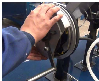
Figura 4.25 Girando el tambor de freno. Fuente: Los Autores
