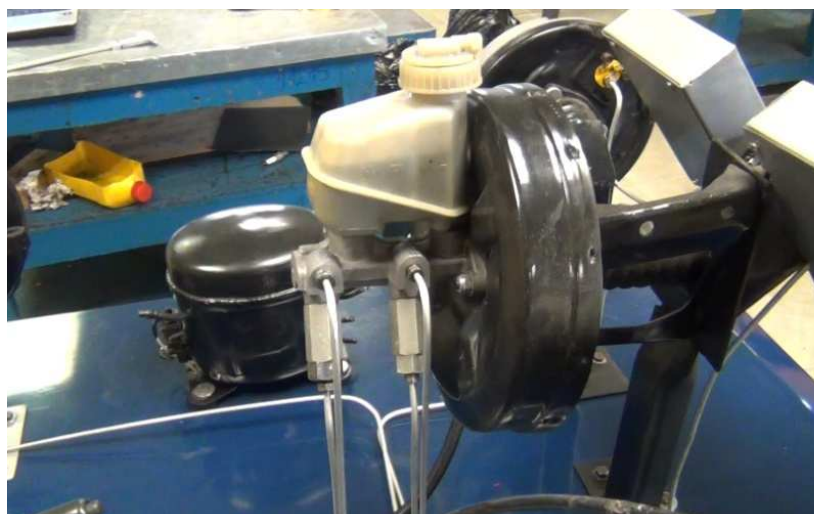
Figura 4.77 Bomba maestra. Fuente: Los Autores
