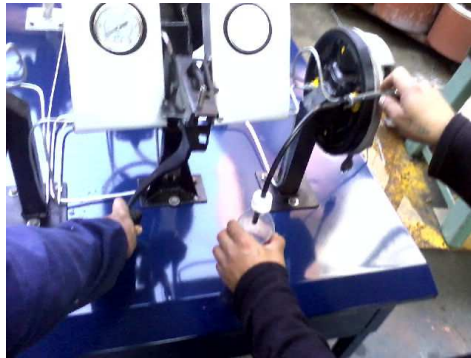
Figura 3.16 Purgado del sistema hidráulico. Fuente: Los Autores
