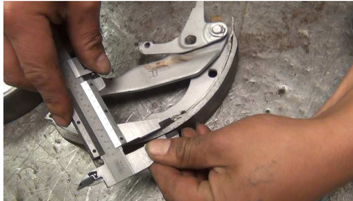
Figura 4.29 Midiendo el espesor de las zapatas. Fuente: Los Autores
