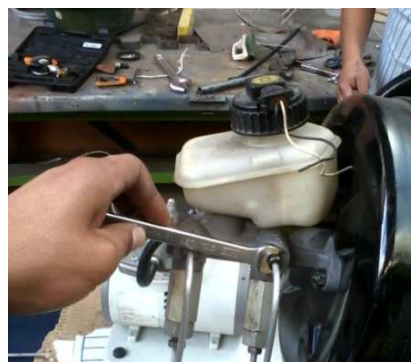
Figura 3.15 Apriete de neplós. Fuente: Los Autores
