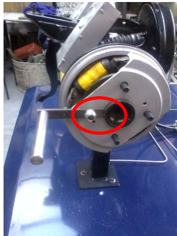
Figura 4.3 Sacando tuercas que sujetan al tambor. Fuente: Los Autores
