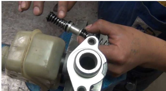
Figura 4.73 Lubricación de elementos internos de la bomba maestra. Fuente: Los Autores
