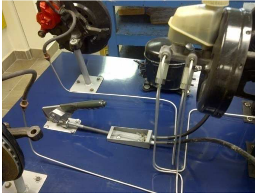
Figura 4.82 Sistema de freno de mano. Fuente: Los Autores
