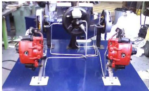
Figura 3.14 Circuito hidráulico totalmente instalado. Fuente: Los Autores
