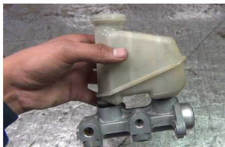
Figura 4.62 Bomba principal. Fuente: Los Autores
