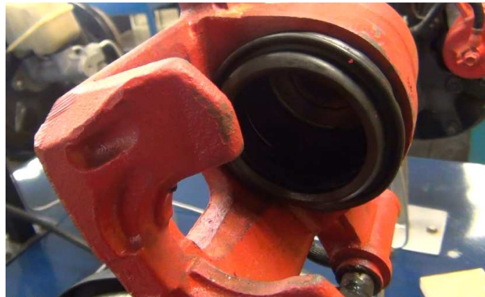
Figura 4.46 Estado de caucho retenes. Fuente: Los Autores
