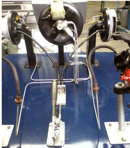
Figura 3.19 Instalación de los cables. Fuente: Los Autores
