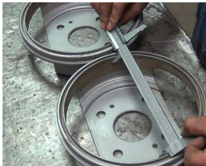
Figura 4.30 Midiendo el diámetro de los tambores de freno. Fuente: Los Autores
