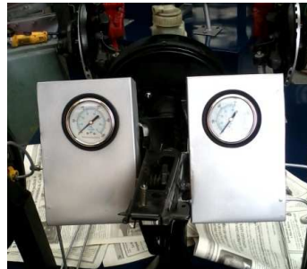
Figura 3.11 Manómetros en sus alojamientos. Fuente: Los Autores
