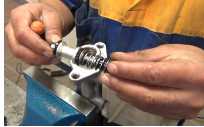
Figura 4.66 Comprobaciones en la bomba maestra. Fuente: Los Autores
