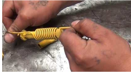
Figura 4.26 Comprobación de muelles de recuperación. Fuente: Los Autores
