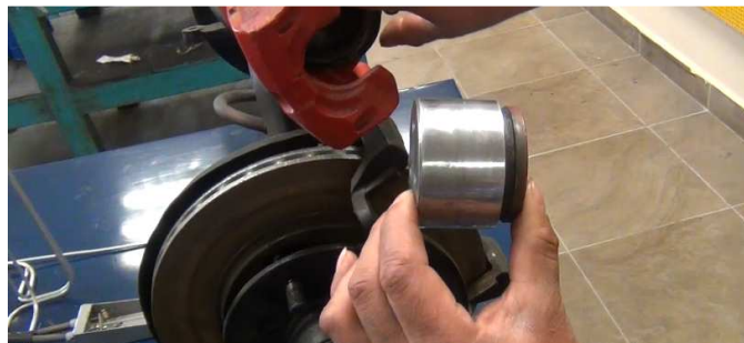
Figura 4.20 Lubricación de elementos para el montaje. Fuente: Los Autores
