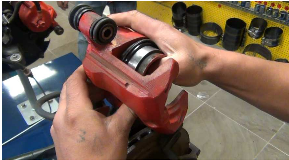
Figura 4.21 Instalación del pistón en su alojamiento en la mordaza. Fuente: Los Autores
