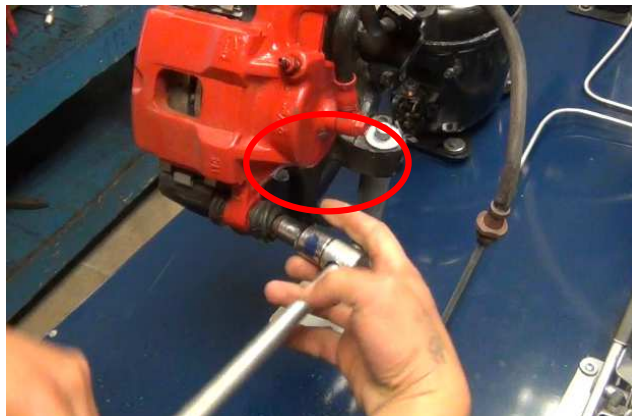
Figura 4.9 Sacando perno guía de la mordaza. Fuente: Los Autores
