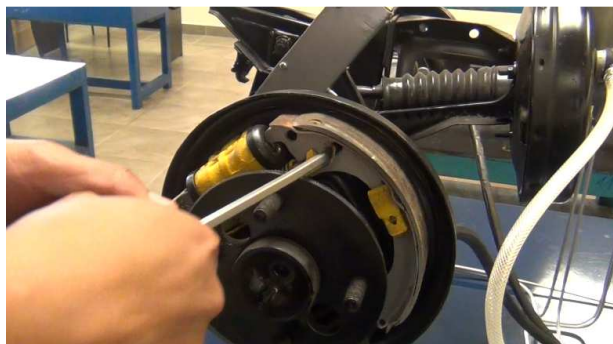
Figura 4.17 Instalación de muelles de recuperación de las zapatas. Fuente: Los Autores
