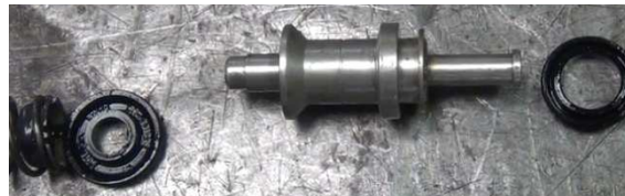
Figura 4.67 Comprobaciones en el pistón, muelles y cauchos retenes. Fuente: Los Autores
