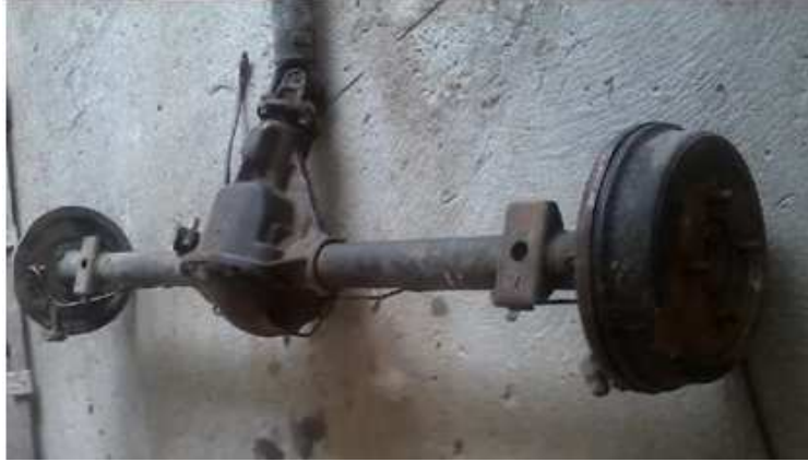
Figura 3.1 Puente posterior con tambores de frenos. Fuente: Los Autores
