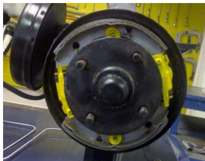
Figura 4.35 Sistema de frenos dúplex. Fuente: Los Autores
