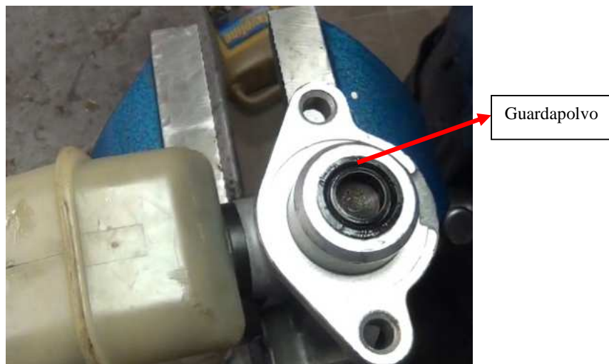
Figura 4.70 Comprobaciones en el retén. Fuente: Los Autores
