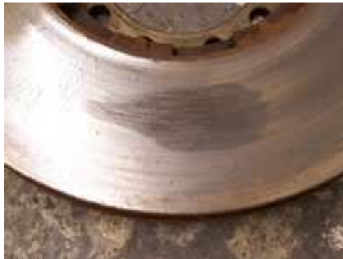
Figura 4.43 Cristalización del disco de freno. Fuente: Los Autores
