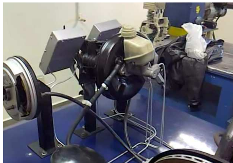
Figura 4.79 Comprobación del servofreno. Fuente: Los Autores
