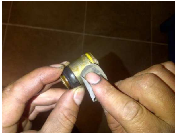
Figura 4.37 Limpieza del pistón. Fuente: Los Autores
