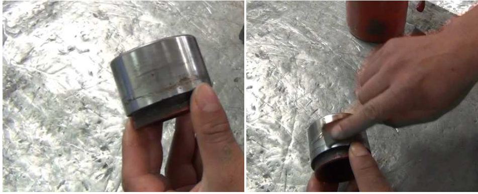
Figura 4.47 Limpieza del pistón. Fuente: Los Autores
