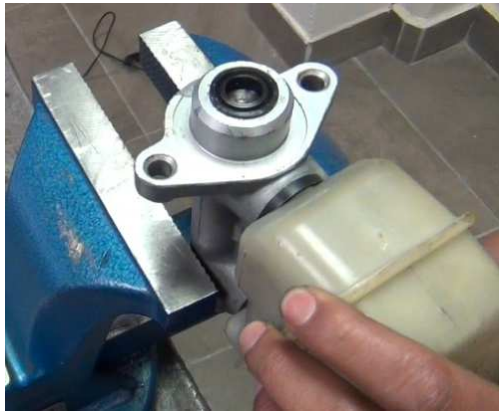
Figura 4.63 Bomba principal montada en una entenalla. Fuente: Los Autores
