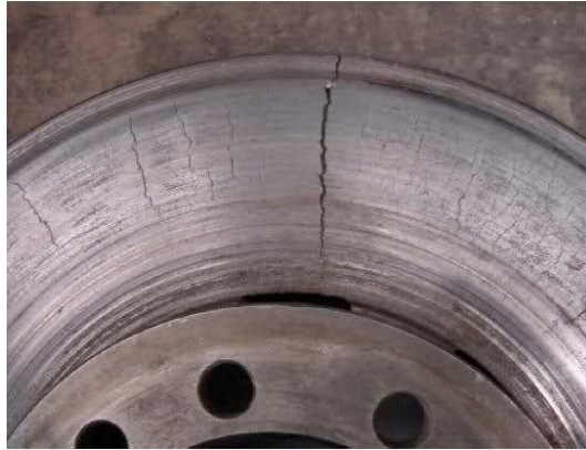
Figura 4.42 Disco de freno roto. Fuente: Los Autores
