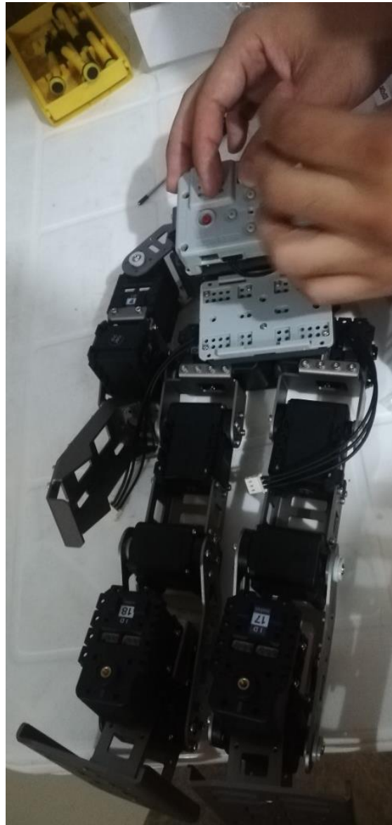
Figura 55. Ajuste del controlador CM-530
