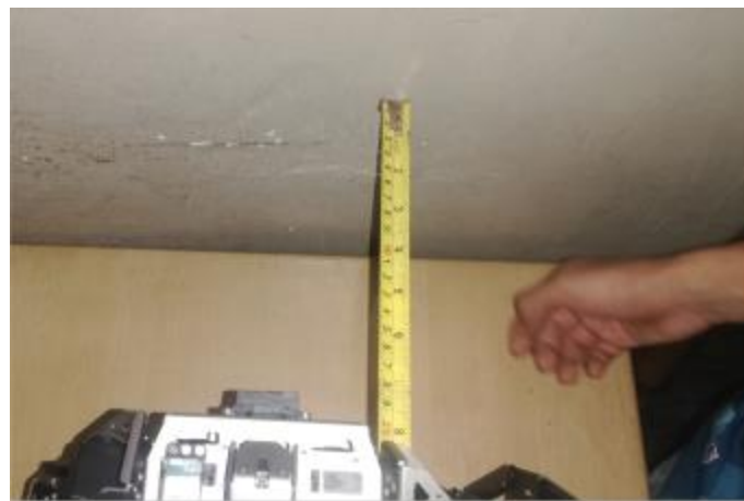
Figura 58. Prueba del sensor DMS-80 a 20cm de distancia
