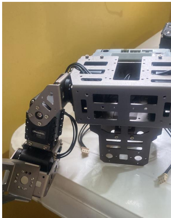
Figura 54 Ensamblaje del torso y brazo del Robot Bioloid GP
