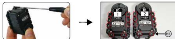
Figura 25. Tuercas ID1 e ID2 del AX-12+.
