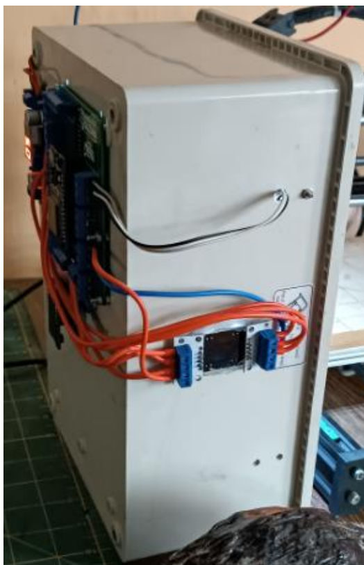
Figura 30. Parte lateral izquierda del sistema de detección de la Monilia Con el sensor de color TCS 3220
