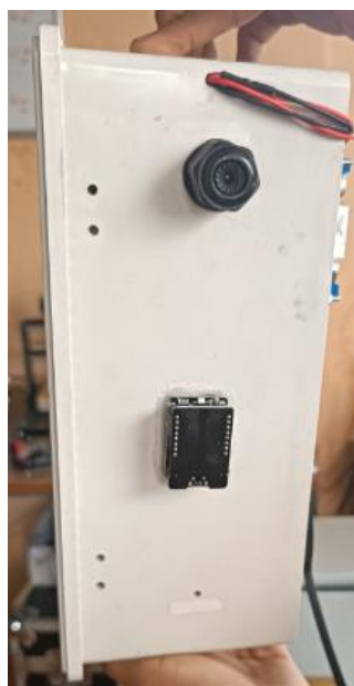
Figura 31. Parte lateral derecha del sistema de detección de la Monilia Con el microcontrolador ESP 32 CAM
