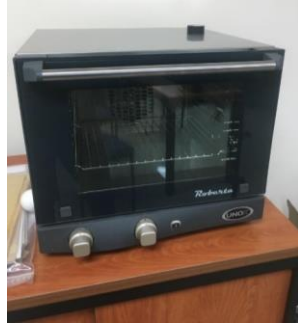
Figura 10. Curado de impresión en horno eléctrico
