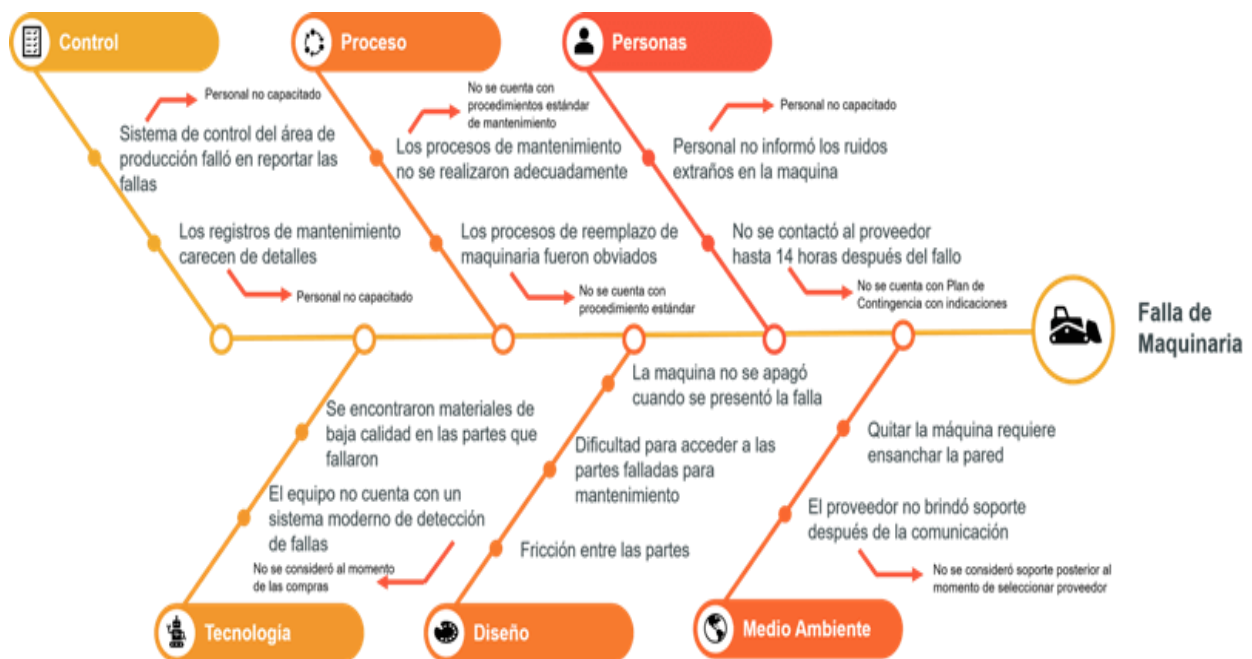
Figura 14 Ejemplo de diagrama causa y efecto Tomado de (Cortez, 2022)
