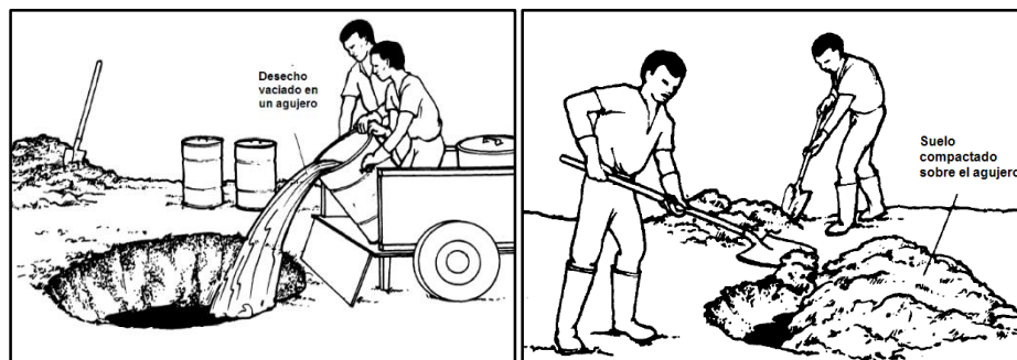
Figura 9. Limpieza del tanque de aireación
