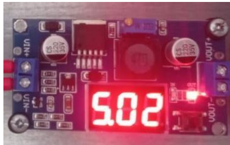
Figura 26. Módulo regulador de voltaje.
