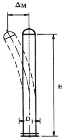
**Figura 22.** Diagrama de deflexión en un recipiente vertical adaptado de [19]
