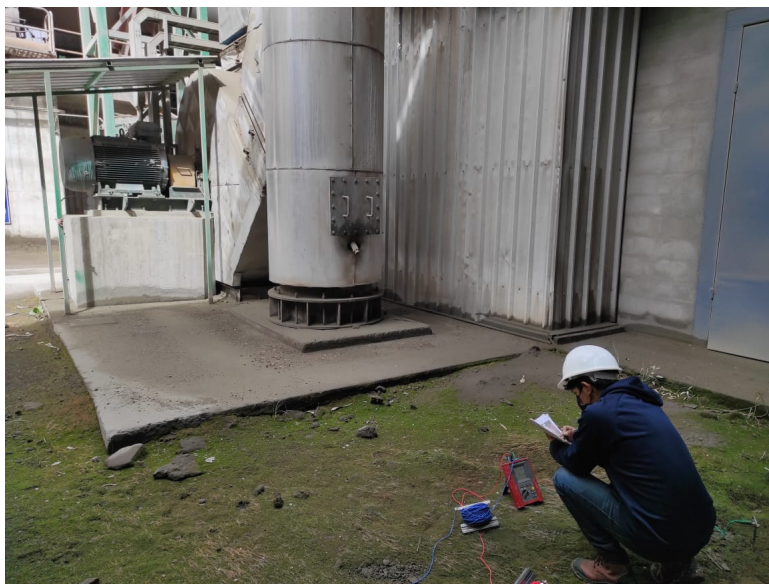
Figura 7.3: Medición de la resistividad del terreno en el área K.
