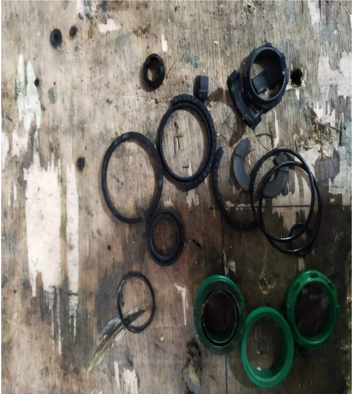
Figura 54. Los empaques en mal estado para se sacaron de los cilindros.
