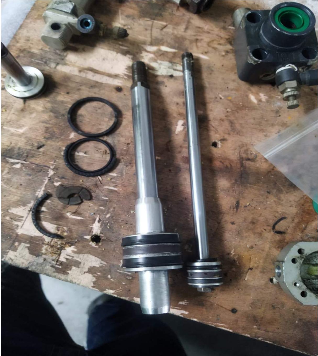
Figura 55. Instalación de los empaques nuevos.
