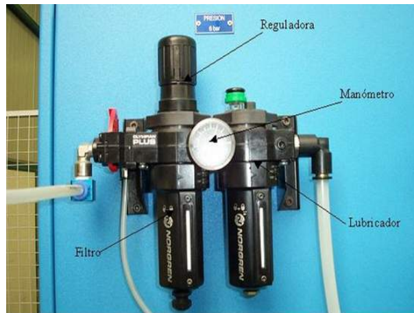
Figura 13. Unidad de mantenimiento neumática y sus partes. Tomado de (BIRT, 2022).
