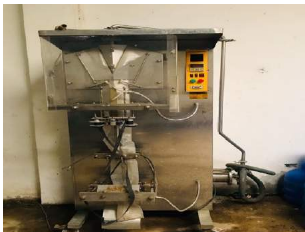
Figura 9. Selladora y empacadora de líquidos. Adaptado de Selladora Continua (Morales, 2022).
