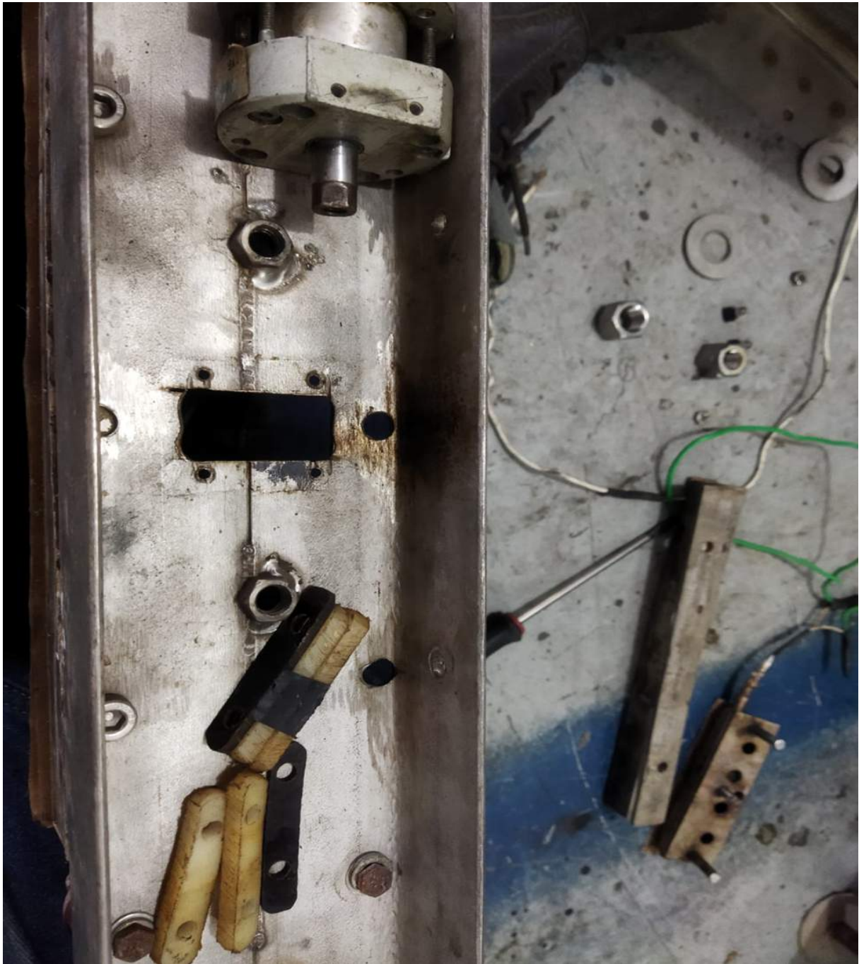
Figura 52. Limpieza del cilindro de perforado.
