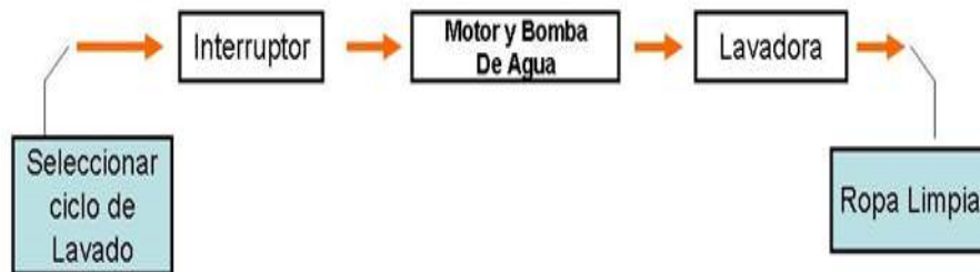
Figura 20. Lazo de control abierto. Adaptado de Sistemas de control (Moya, 2018).
