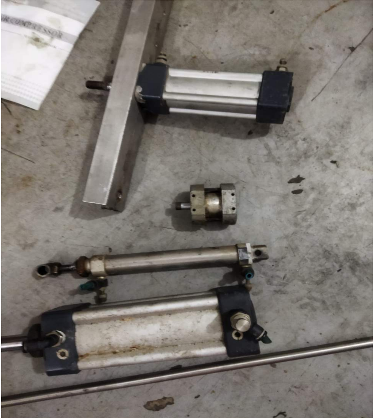
Figura 51. Desinstalando los cilindros de la maquina para realizar el mantenimiento. .
