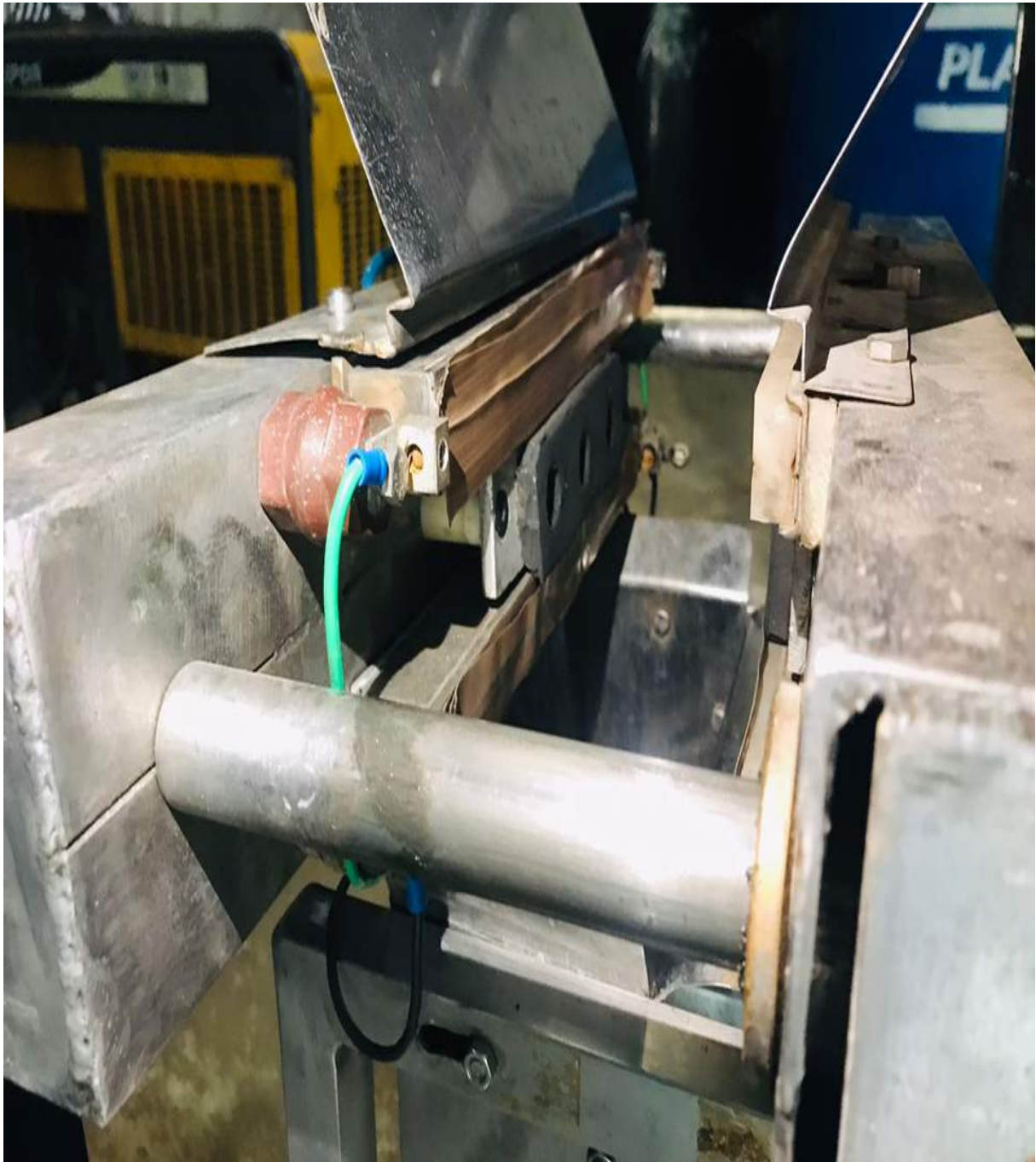
Figura 64. Mordaza de corte y sellado para la presentación de 4 litros.
