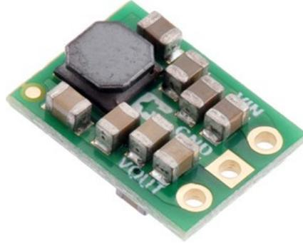
*XI-A7. FUENTE CONMUTADA DE 5 V:* A continuación se muestra una tabla comparativa sobre las fuentes de alimentación Ac-Dc de 5 V.
