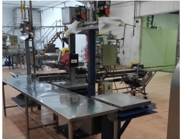
Foto 04: Maquina de llenado de fundas.
