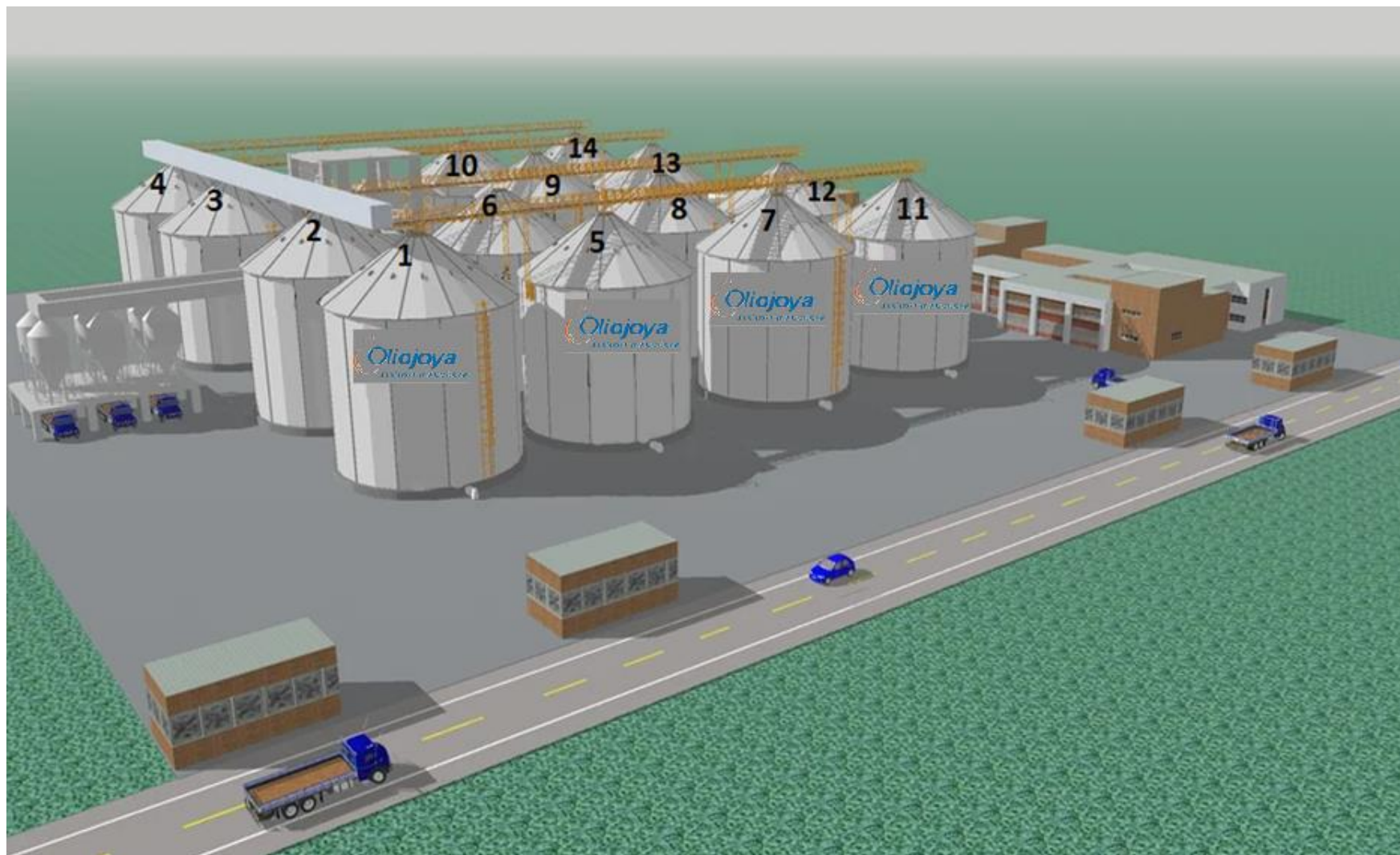
Figura 9. Lay Out de los tanques de almacenamiento
