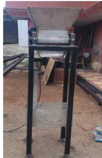
*Fuente: Obtenido de Diseño y construcción de máquina trituradora de hojas de guayusa (tesis)*
