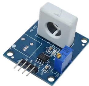
Figura 4.8: Sensor de corriente no invasivo o de efecto hall WCS1800.
