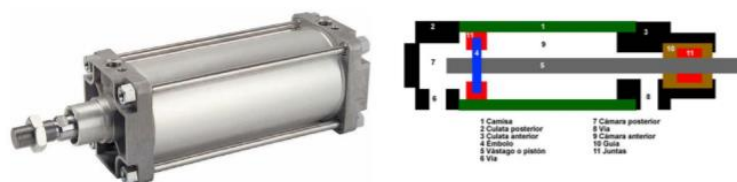
Ilustración 26. Cilindro hidráulico de doble efecto.[37]
