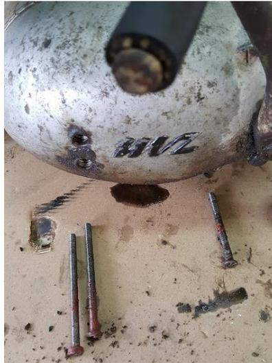
Figura 20 Extracción de pedal de cambios y encendido– Fuente: Autores
