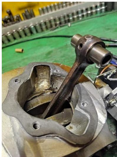
Figura 53 Pistón ensamblado en el brazo de biela. - Fuente: Autores
