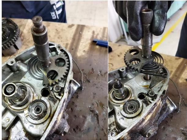
Figura 28 Extracción del eje con leva Fuente: *Autores*
