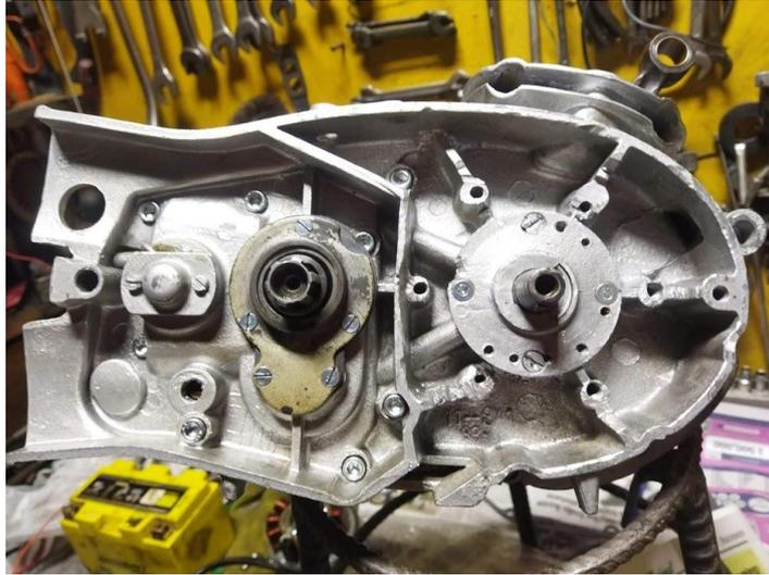
Figura 38 Montaje del sujetador del rodamiento. - Fuente: Autores
