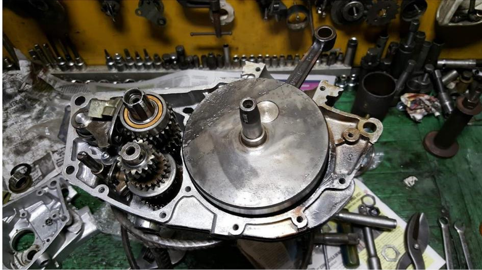
Figura 36 Ensamble cigüeñal. - Fuente: Autores
