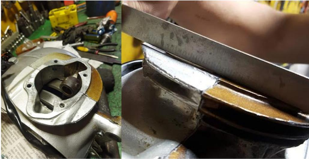
Figura 34 Rectificación del block. - Fuente: Autores
