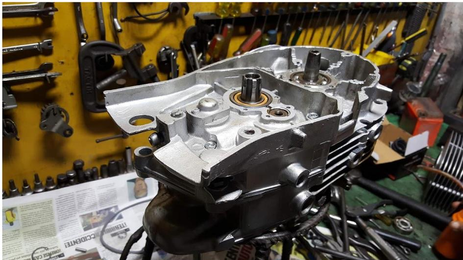
Figura 37 Colocación de empaque. - Fuente: Autores
