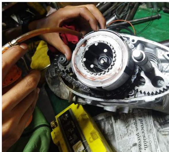
Figura 45 Ensamble de discos de embragues y fricción. - Fuente: Autores
