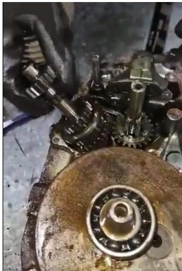
Figura 31 Extracción de engranajes. - Fuente: Autores
