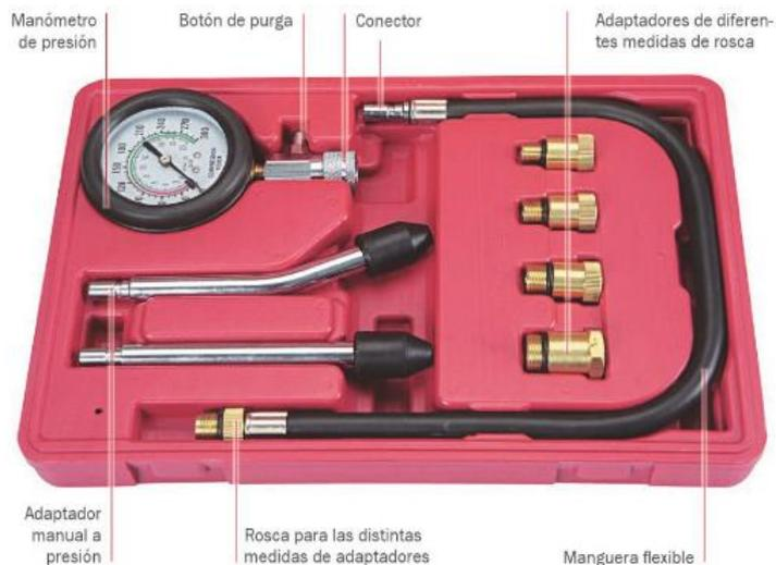
Figura 57 Kit de medición de compresión.- Fuente (Pesis, 2015)
