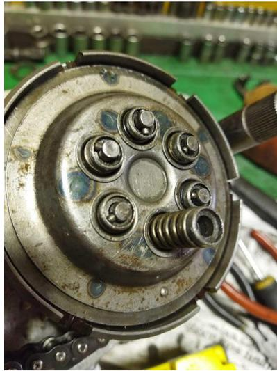
Figura 46 Ensamble del plato de presión. - Fuente: Autores
