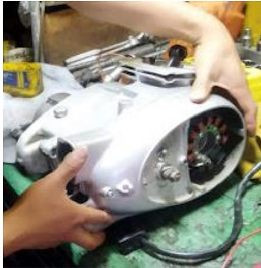
Figura 52 Cierre de carcasa del alternador. - Fuente: Autores
