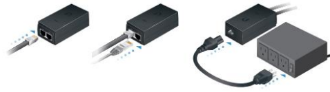
Figura 43: Alimentación de voltaje Antenas
