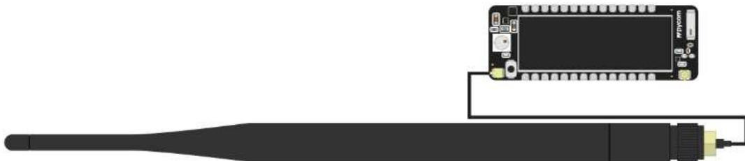
Figura 2.26: Conexión Antena LoRaWAN a Fipy [53]
