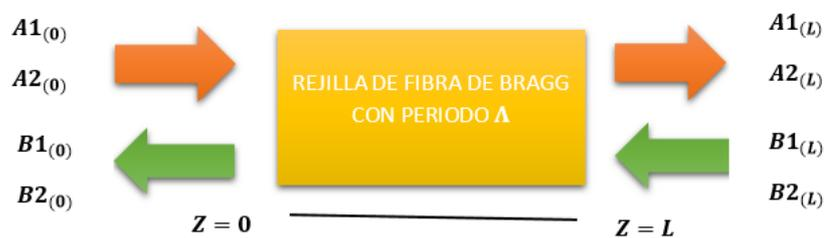
Figura 3.5 Modelo de FBG con dos modos de propagación a lo largo del eje Z
