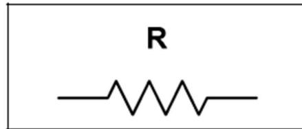
**Figura 07. Resistencia eléctrica**
