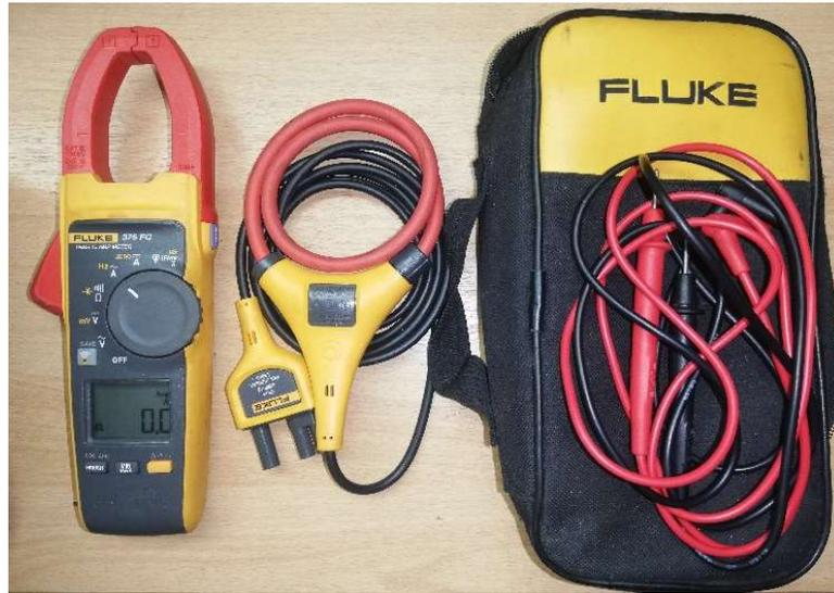
**Figura 71. Pinza amperimétrica Fluke 375FC**
