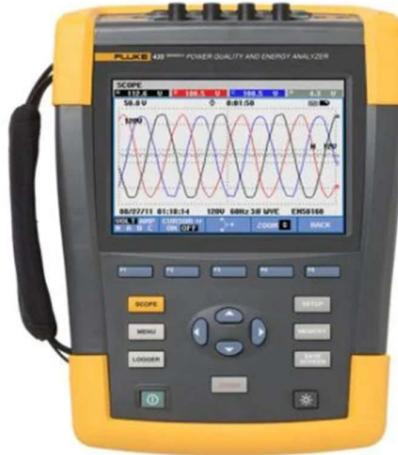
**Figura 49. Analizador de red Fluke 434 y 435**
