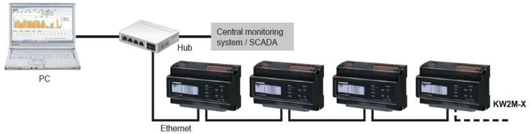
**Figura 60. Comunicación industrial – Ethernet**
