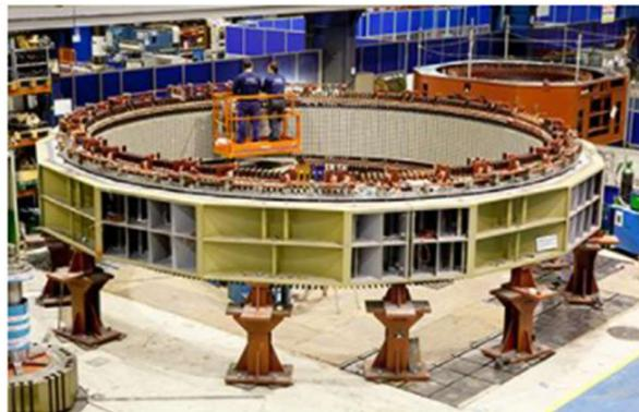
**Figura 03. Generador eléctrico INDAR-Energía hidroeléctrica.**
