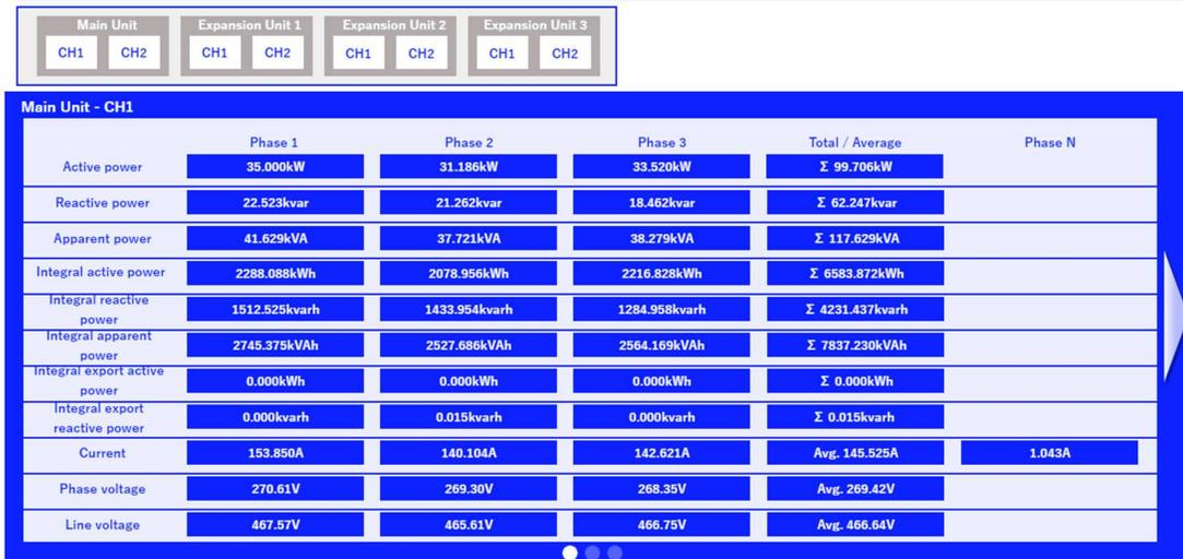
**Figura 92. Monitoreo en tiempo real CH-01 (Compresor SSS-05/Evaporadores)**
