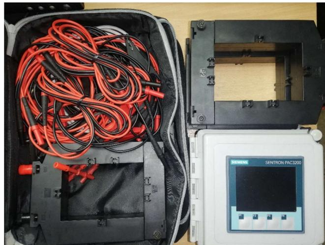
**Figura 74. Multimedidor Siemens SENTRON PAC-3200**
