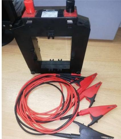
**Figura 75. Transformador de corriente 1000/5 [A].**
