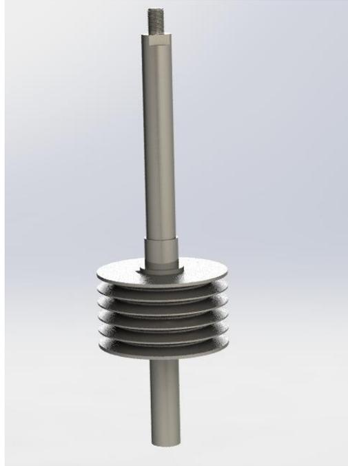
**Figura 39:** Configuración geométrica de eje que mueve la cuchilla.
