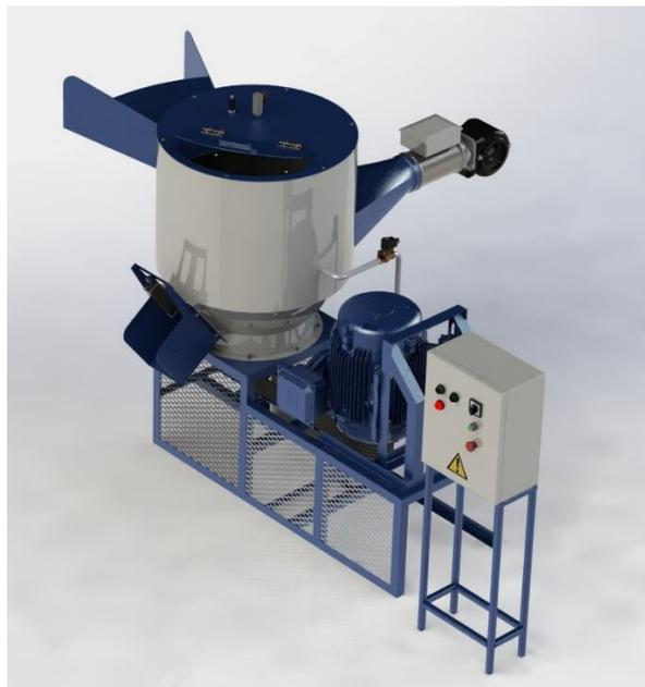
**Figura 70:** Diseño renderizado del equipo de lavado y secado de plástico – Perspectiva 1.
