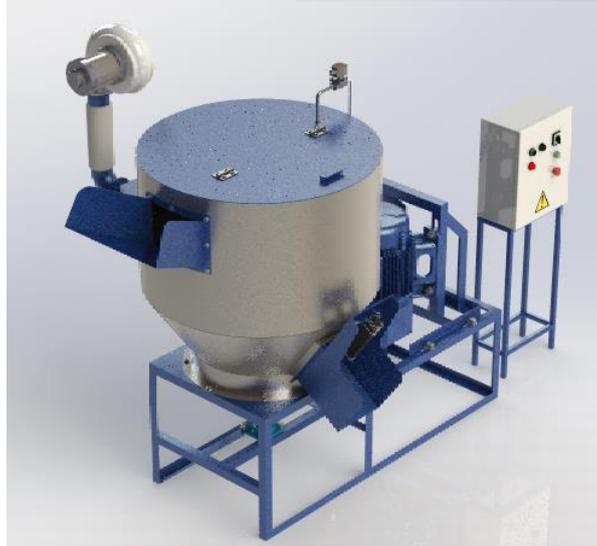
**Figura 36:** Diseño de la maquina lavadora y secadora de plástico reciclado.
