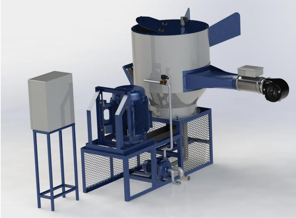
**Figura 71:** Diseño renderizado del equipo de lavado y secado de plástico - Perspectiva 2.
