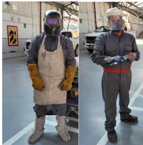
*Ilustración 41 EPP de los técnicos.
