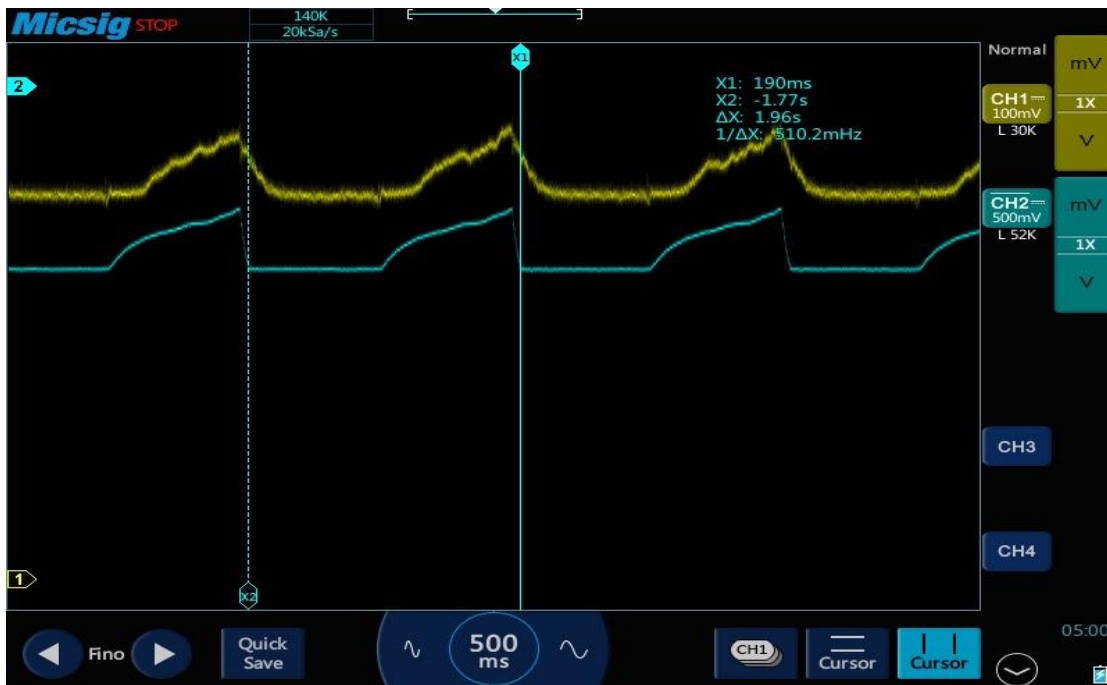
Figura 52.- Representación con el osciloscopio de la curva - sensor FTPS
