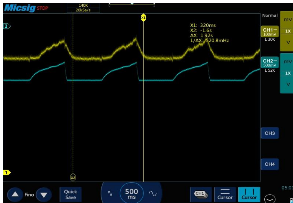
Figura 53.- Representación con el osciloscopio de la curva - sensor MAF
