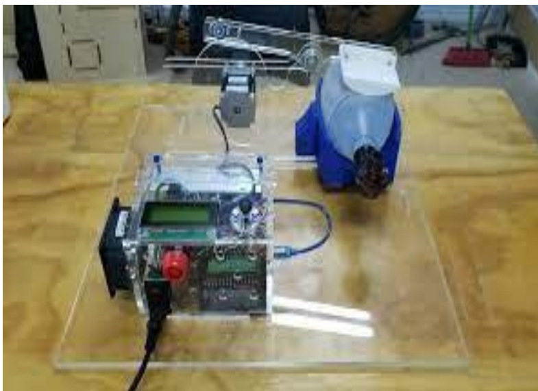
Figura 3.- Prototipo ventilación mecánica de UTA.
