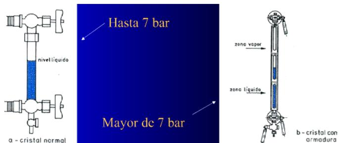
**Figura 1.3.** Medición de nivel de cristal
