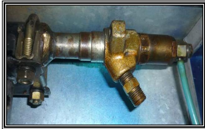
**Figura 2.20.** Válvula de sobrepresión
