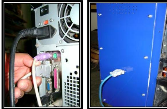
**Figura 6.6.** Conexión del banco al PC. Vía DB9
