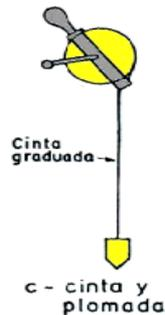
**Figura 1.2.** Medición de cinta plomada
