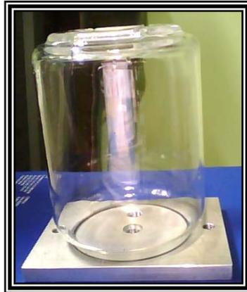
**Figura 2.8.** Cámara para la atomización
