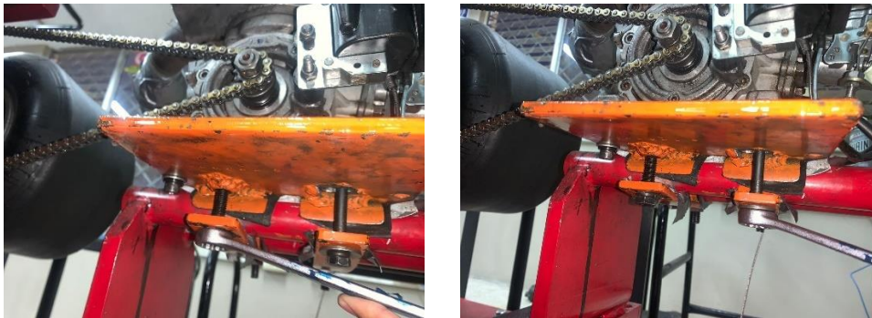
Ilustración 20: Ajuste de pernos en la base del motor.
