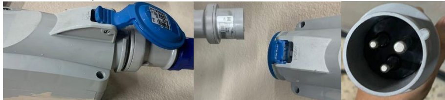
Ilustración 6: Conexión de la toma trifásica.
