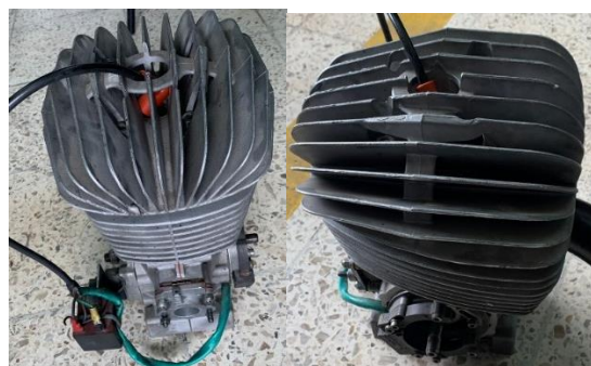
Ilustración 4: Motor IAME Parilla Sudam 125cc
