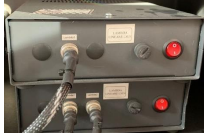
Ilustración 8: Revisión de alimentación del sensor TPS
