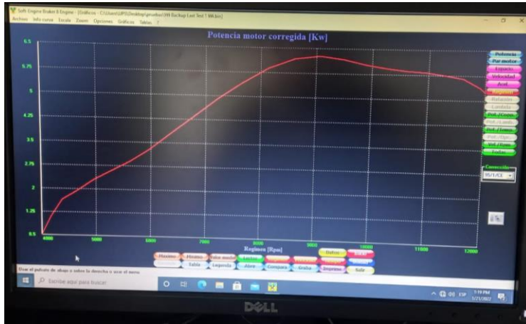
Ilustración 21: Curva de potencia medida.
