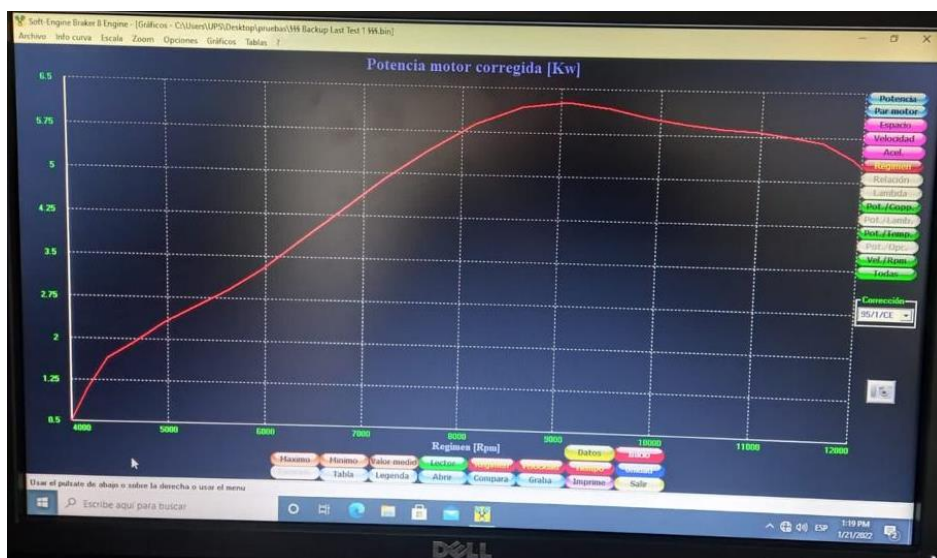
Figura 31: Medición de potencia con carburador nuevo - Fuente: Autor.
