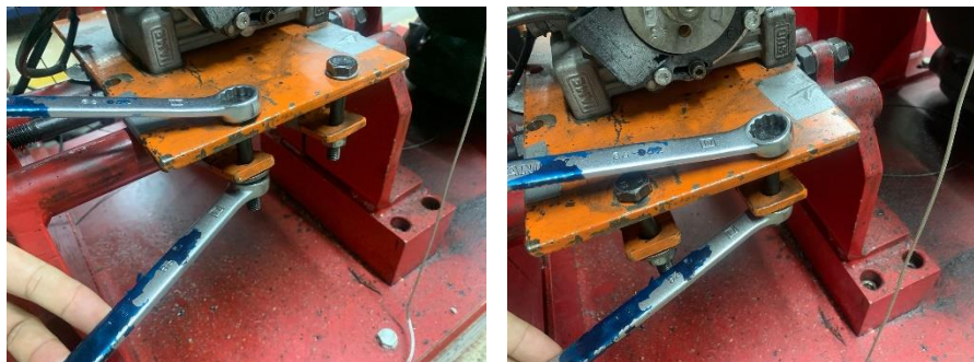
Ilustración 17: Ajuste de pernos en la base del motor.
