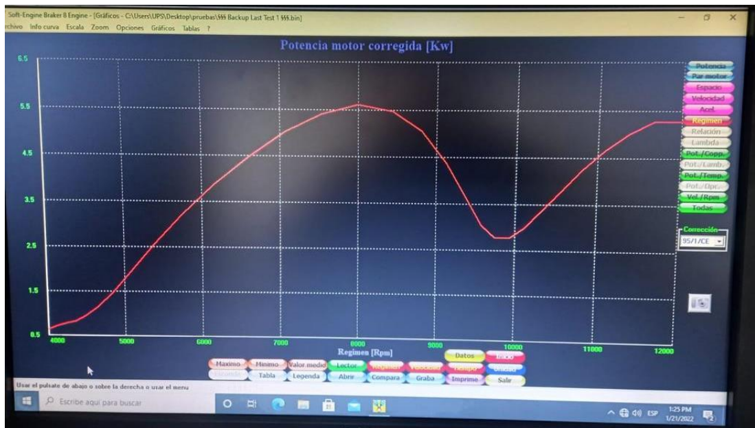
Figura 30: Medición de par y potencia con el nuevo carburador - Fuente: Autor.
