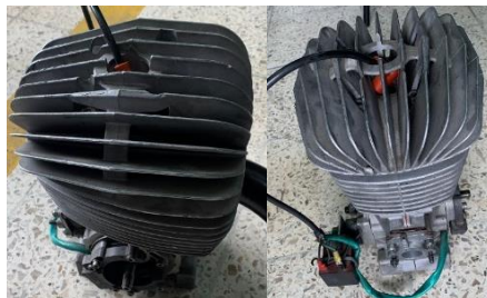
Ilustración 2: Motor IAME Parilla Sudam 125cc
