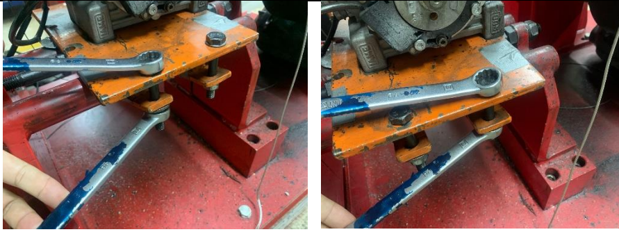
Ilustración 19: Ajuste de pernos en la base del motor.
