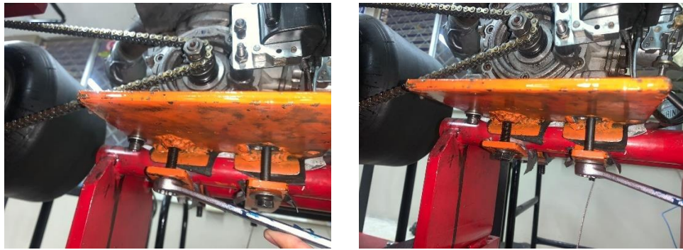
Ilustración 18: Ajuste de pernos en la base del motor.
