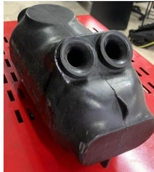
Figura 6: Depurador de aire - Fuente: Autor.
