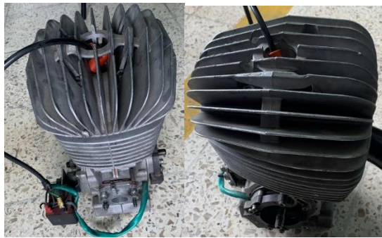
Ilustración 6: Motor IAME Parilla Sudam 125cc
