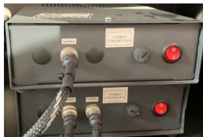
Ilustración 8: Revisión de alimentación del sensor TPS
