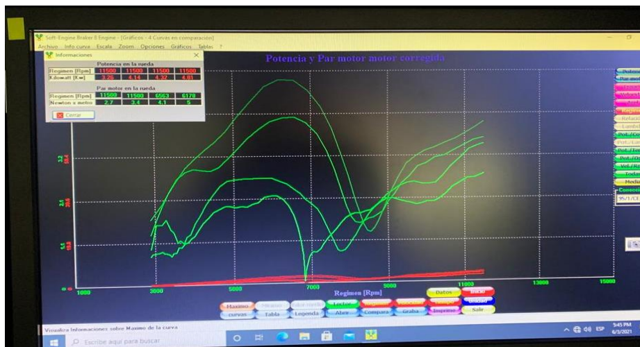
Figura 29: Mediciones de par y potencia con la calibración del carburador - Fuente: Autor.
