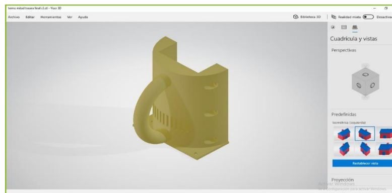
Figura 23. Diseño 3D parte trasera contorno del termo.
