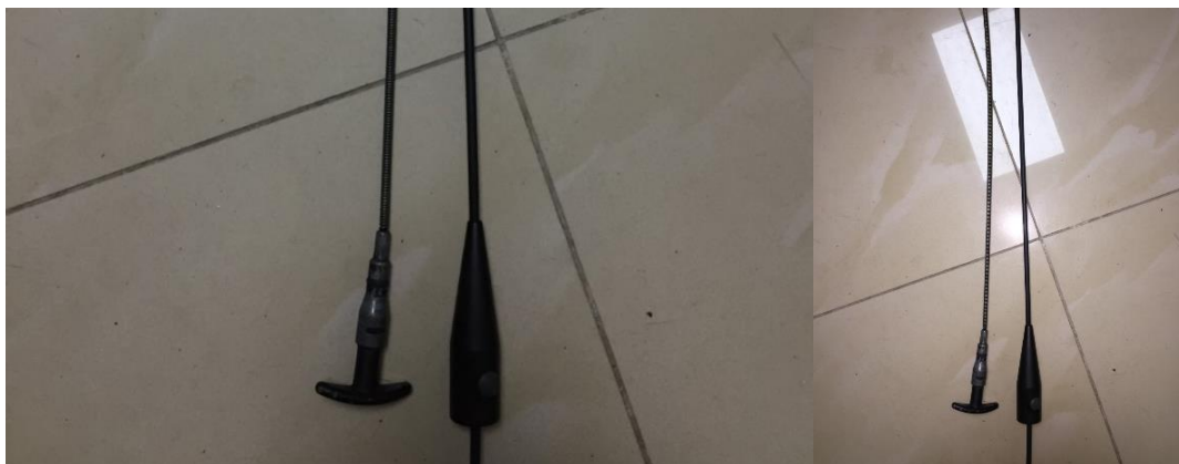
Figura 3.9. Sensor de temperatura del aceite. Fuente: Autor
