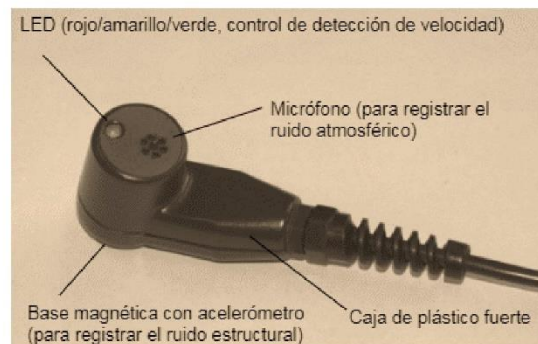
Figura 2. Sensor permanente con pie magnético Fuente: https://www.maha.com
