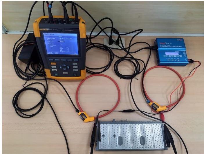
Figuras 23: Conexiones del equipo iMax b6 AC y Fluke 430 Series II a la celda de Níquel Metal Hidruro.
