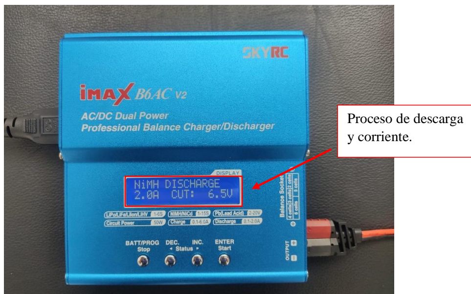
Figuras 16: Parámetro para Descarga de la batería de Níquel Metal Hidruro.
