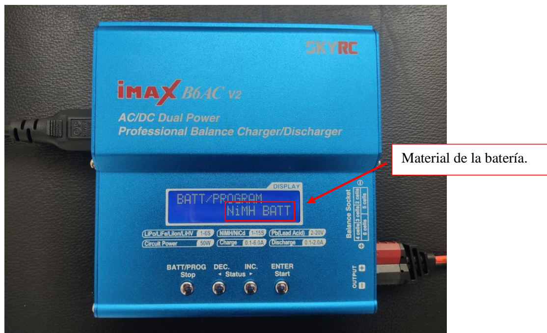
Figuras 14: Parámetro del tipo de material en el cargador DC.
