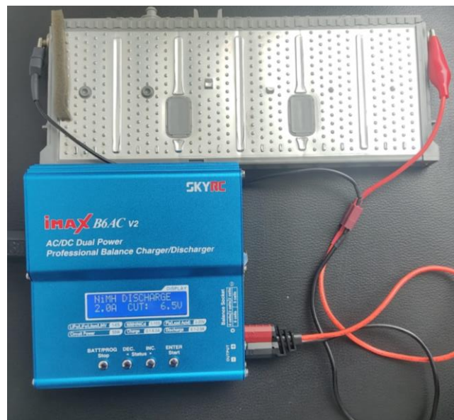
Figuras 22: Conexión y definición de parámetro de descarga de la celda de Níquel Metal Hidruro.
