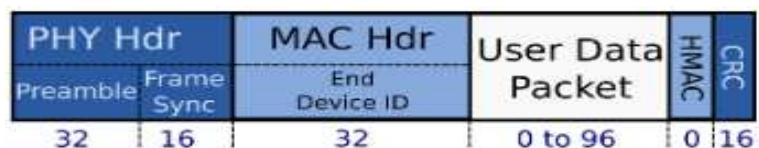
Figura 5. Estructura de un paquete en SigFOX (5).
